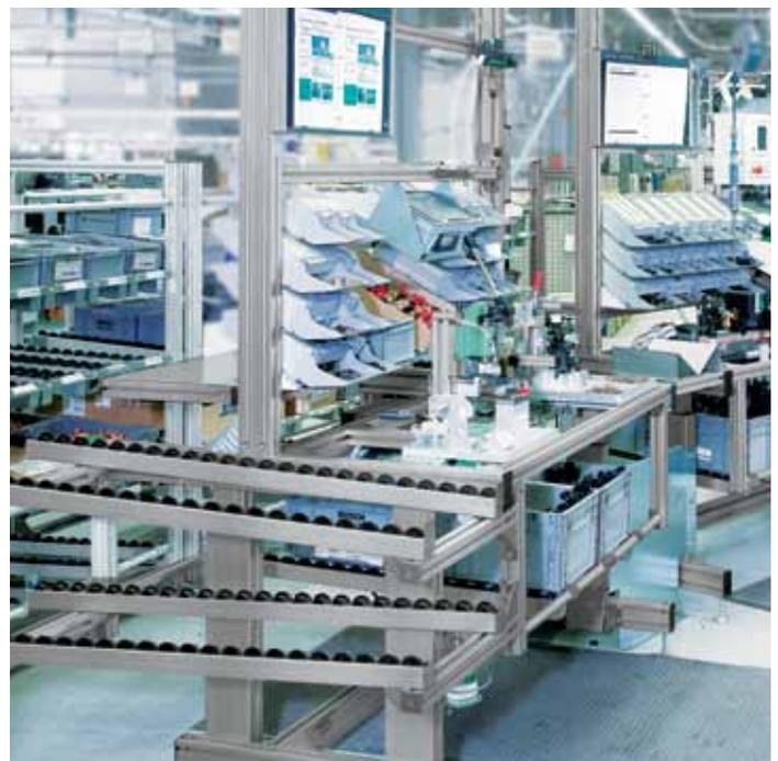
sants de rayonnage peuvent également être combinés aux postes de travail. L'avantage des voies par rapport aux niveaux de matériaux est la mise à disposition définie et exacte des bacs. Les bacs ne peuvent pas glisser ou être intervertis, car les différentes voies sont réglées sur les bacs correspondants.
